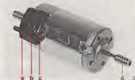
Bild 3 LGB-Hochleistungsmotor a) Herausgezogener Isolierkopf mit Führungskanal für Motorkohlen b) Drossel-Spulen zur Funkentstörung c) Zweigängige Getriebsbesnecke. Motor-Leistungsdaten (Durchschnittswerte) Drehmoment M_d = 0,4-0,6 \text{ Ncm}^* Drehzahl n = 7000-11000 \text{ U/min} Stromaufnahme J = 300-500 \text{ mA} Leistung P_{ab} = 3-7 \text{ Watt} Motor-Wirkungsgrad \eta = 67\% Alle Meßwerte bei mittlerer Zugleistung mit 10 Wagen in der Ebene. * (1 Newton ca. 100 g)
